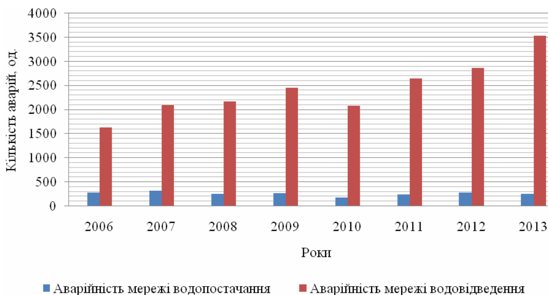
Рис. 2.16. Аварійність мереж водопостачання та водовідведення в м. Коростень
